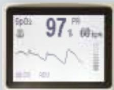
Il monitor base indica tutti i parametri e le funzioni: parametri rilevati incluso la forma d'onda, data, ora, carica della batteria.
