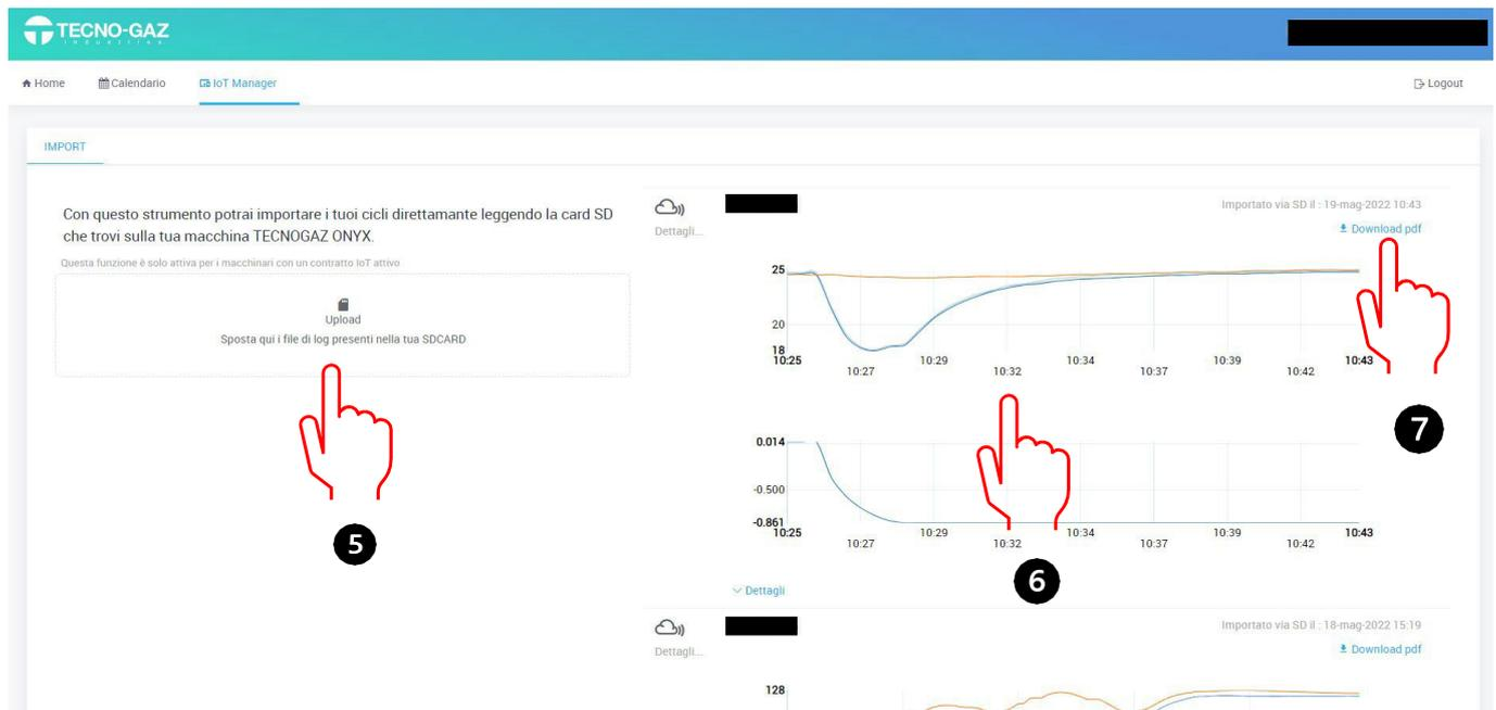
Sur le côté gauche de l'écran, l'utilisateur a la possibilité de télécharger des cycles à partir de la carte SD en appuyant sur le bouton "Télécharger". (5).
