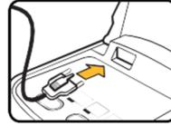
**Abbildung 9. TECNOHEART plus: Symbol für Fehlender Anschluss der Elektroden**
